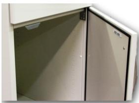
Die Flügeltüren sind mittels eingliedrigem Weitwinkelscharnier angeschlagen. Die Öffnungswinkel betragen 210 Grad bei Einzelaufstellung und 135 Grad bei Reihenaufstellung.
