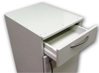
Die Schubladen laufen auf wälzlergeführten, geräuscharmen Präzisionsteleskopschienen mit Vollauszug und Selbsteinzug und sind bis 40kg belastbar.
